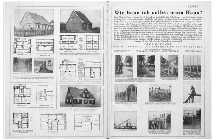
Figure 13 Floor plans, structure, and assembly of the Normalbausystem. Archived in: Thüringer Hauptstaatsarchiv Weimar, “Aus dem Prospekt für das Normal- und Selbstbausystem Olof Boecker,” Staatliches Bauhaus Weimar, Nr. 201, 62.
